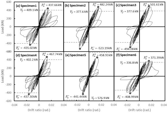
Fig. 3 Load-Drift ratio
